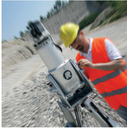
Rilievo di cava con laser scanner 3D
